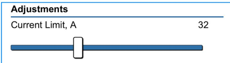
**Remarque :** Seuls les réglages du courant maximal égaux ou inférieurs aux réglages des commutateurs DIP s'affichent. Voir le manuel d'installation pour plus d'informations sur la modification des réglages du courant maximal à l'aide des commutateurs DIP.
